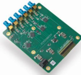
6通道 FPD-Link III 解串器板, 适用于 NVIDIA® Jetson AGX Xavier™ 开发套件
